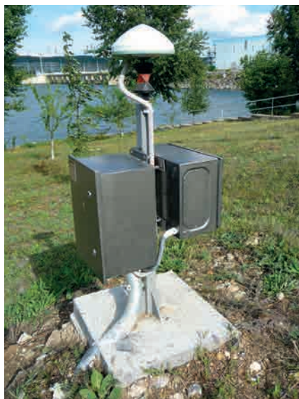
Figure 8. Point de contrôle actif GNSS à Dniestr en Ukraine.
