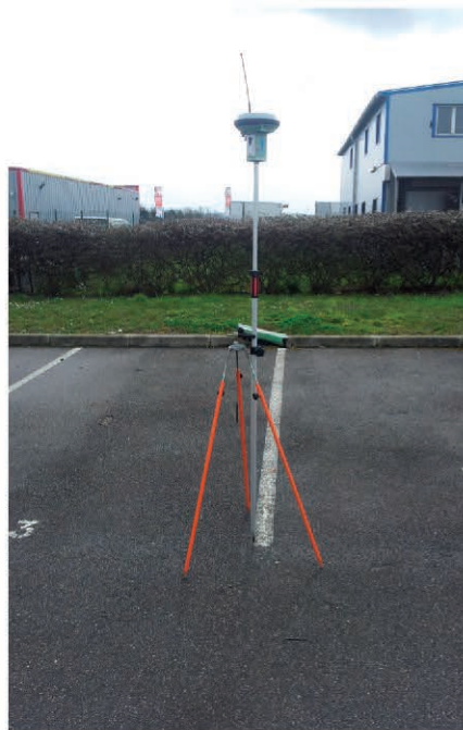
Figure 1. Pivot ou Base RTK et récepteur mobile GNSS. A noter que dans le cadre de la méthode NRTK, seul le mobile est nécessaire.
