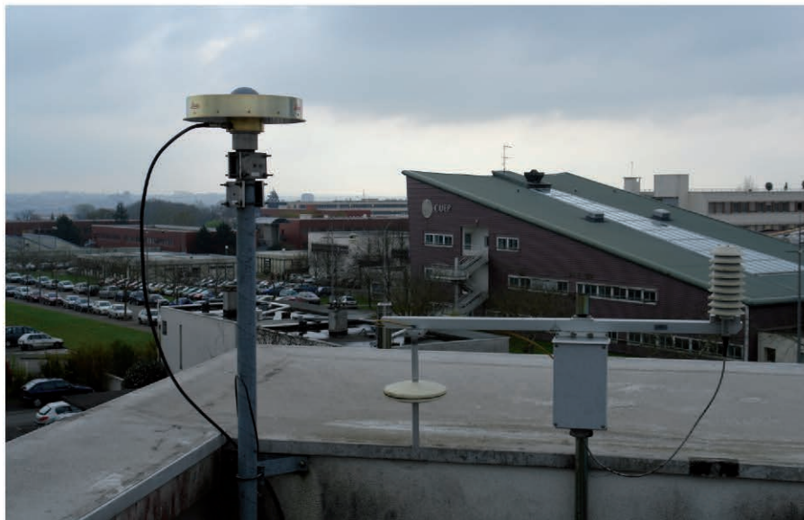
Figure 3. Station de référence permanente.
