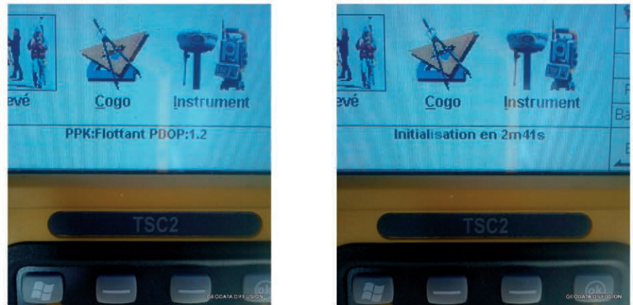
Figure 4. Affichage du statut du mode PPK sur le mobile et temps d'initialisation restant afin de pouvoir traiter la chaîne cinématique suivant les modalités des éléments de configuration repris Figure 3.
