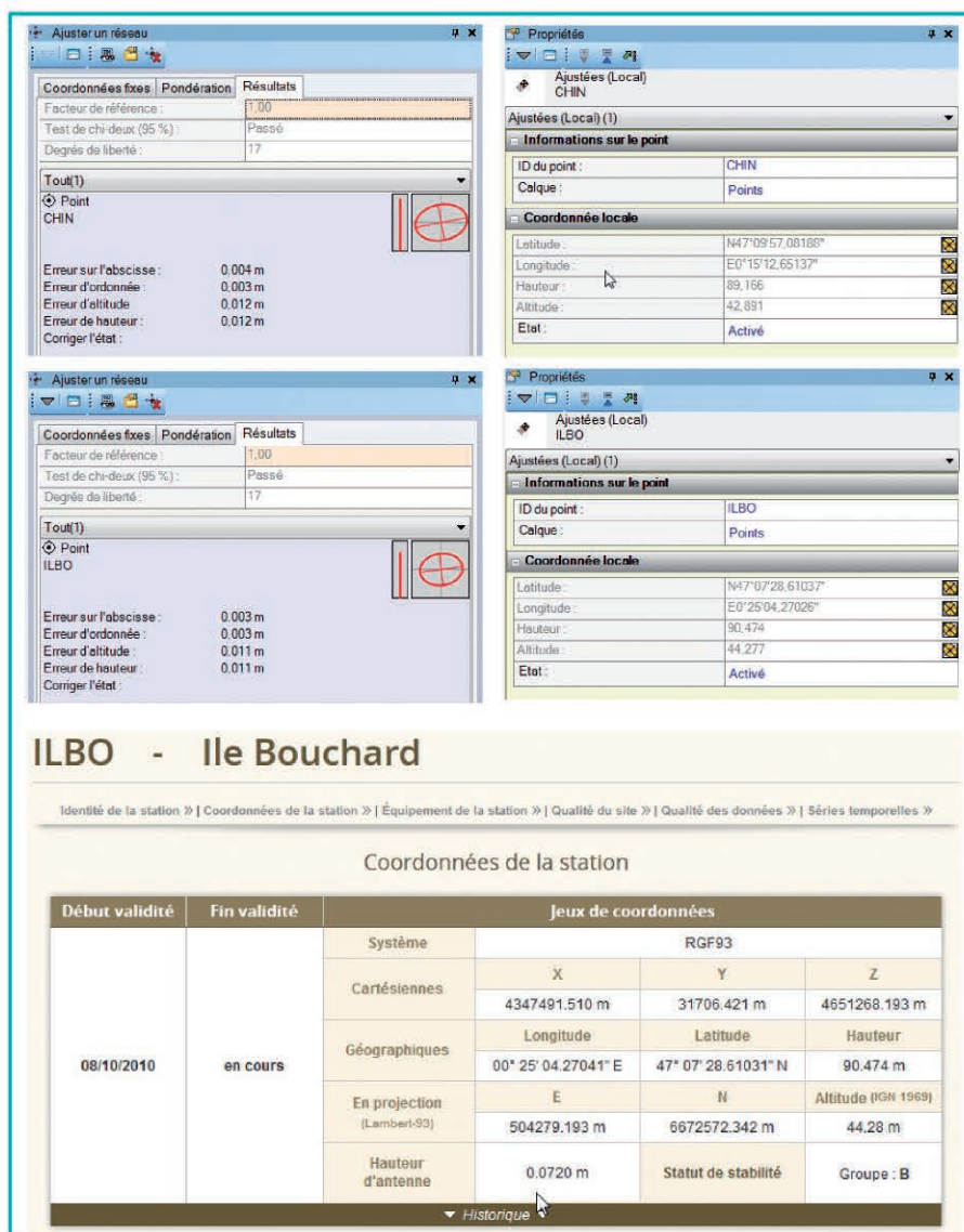
Figure 10. Résultats pour la station CHIN pour le cas évolué "en réseau" et contrôle sur la station RGP ILBO en considérant ses coordonnées publiées sur le site du RGP ( http://rgp.ign.fr/STATIONS/#ILBO ).
