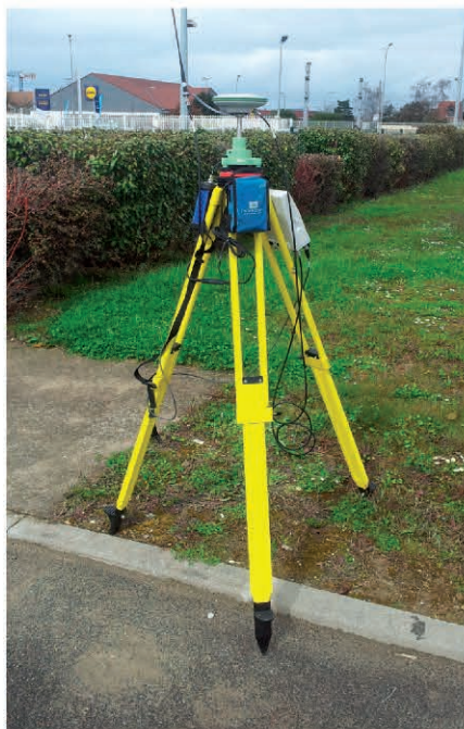
Figure 1. Pivot ou Base RTK et récepteur mobile GNSS. A noter que dans le cadre de la méthode NRTK, seul le mobile est nécessaire.
