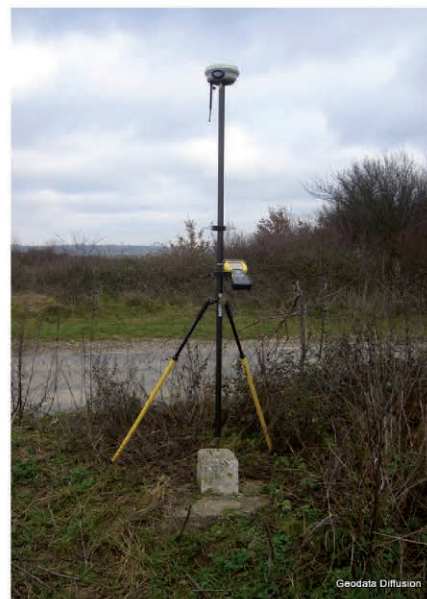
Figure 3. Mobiles GNSS (LEICA VIVA GS15 et TRIMBLE R6) utilisés sur la borne RBF 6927001-A pour le lever servant d'exemple.
