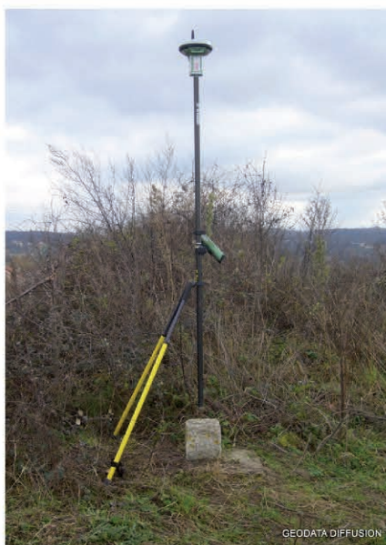
Figure 3. Mobiles GNSS (LEICA VIVA GS15 et TRIMBLE R6) utilisés sur la borne RBF 6927001-A pour le lever servant d'exemple.
