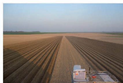
Figure 4. Système de guidage automatisé NRTK pour engins agricoles (travail du sol, semis de carottes et traitements phytosanitaires en une seule opération avec une précision centimétrique).
