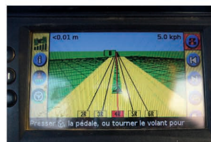
Figure 4. Système de guidage automatisé NRTK pour engins agricoles (travail du sol, semis de carottes et traitements phytosanitaires en une seule opération avec une précision centimétrique).
