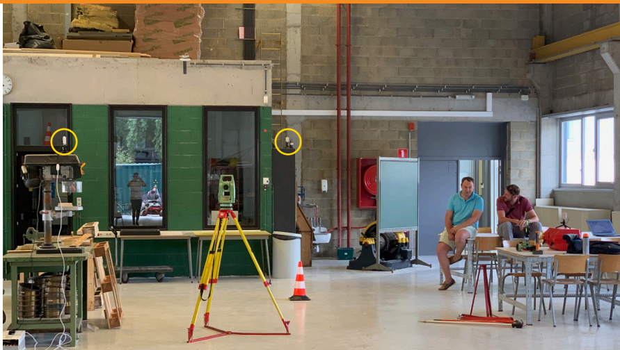
Figure 3. détermination des coordonnées 3D des ancrés en utilisant une station totale permettant la mesure de distance sans réflecteur.
